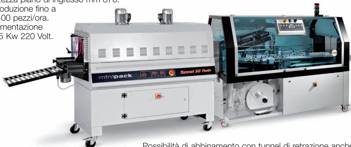
Possibilità di abbinamento con tunnel di retrazione anche a doppia camera di riscaldamento con regolazione separata. Display digitale con 9 programmi personalizzabili. Potenza massima installata 13,2 Kw 380 Volt.
