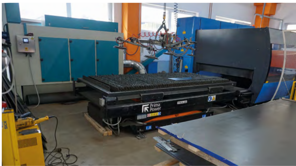
Esempio di utilizzo di un dispositivo di aspirazione in connessione con un laser
